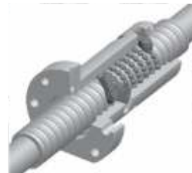
Fig. 3.8 Tuerca tipo recirculación simple interna
